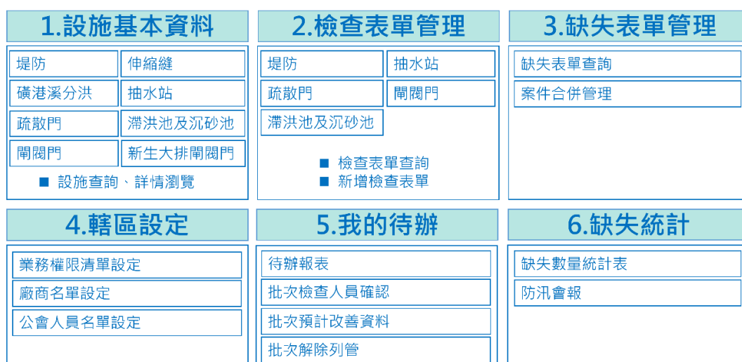
圖 8 新式水利建造物檢查管理平台架構
